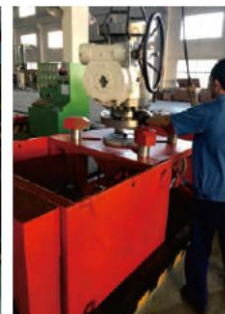
静水压试验示意图
